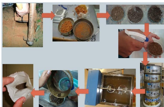
Figura 2. Procedimento para determinação da estabilidade de agregados em água. Fotos: L. A. Rangel, 2012.
